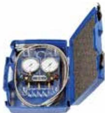
Kit compuesto por: maletín, analizador de pistón de 2 válvulas con manómetros inox. de glicerina, -1 +100 bar/0 +160 bar y 3 mangueras de alta presión inox. de 1500 mm.
