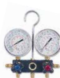
Analizador de 2 válvulas de membrana con manómetros clase 1
