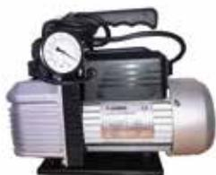
Bomba de vacío doble efecto equipada con electroválvula y vacuómetro, 1/3 HP, conexión 1/4" M SAE.
