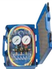
Kit compuesto por: maletín, analizador de 2 válvula, manómetros, 3 mangueras de 1500 mm. de 1/4 (serie A6), 5/16 (serie A4) y 1/4x5/16 (serie D1) y adaptador H 1/4 x M 5/16 en serie A4.
