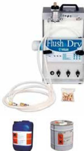
Las estaciones de lavado permiten la limpieza en circuitos frigoríficos eliminando aceites y residuos sólidos. Equipadas con bomba de 14 l/min, depósito de 10 l, conexión para nitrógeno, filtro y mangueras 1/4", 3/8" y 1/2" SAE. El modelo Flush&Dry incorpora reductor y cartucho de 950 cc. de nitrógeno para barrido. Alimentación 230-240v/1/50-60 hz., peso 13/14 kg.
