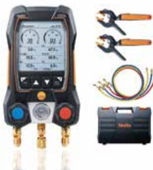
Analizador de refrigeración digital con Bluetooth para smartphone de 2 válvulas para mantenimiento y reparación de sistemas de refrigeración y aire acondicionado. Rango de -1 a 60 bar, resolución 0,01 bar. Incluye protocolo de calibración.
