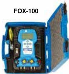
Analizador digital de 4 vías de pistón, más de 50 refrigerantes (CFC, HCFC, HFC, HFO). Rango de presión -0,99 a 49,9 bar, máxima presión de trabajo 56 bar, precisión mayor 1%. Sondas de temperatura tipo k con cable de 3 m., rango -99,9 a 200 °C. Incluye R32 y R1234ze
