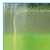
Refrigerante y aditivo con contaminación de agua
