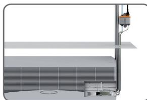
El bloque de detección se conecta a la salida de la bandeja de condensados.
