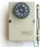
F-2000 y A-2000 : Termostatos en estuche .F-2000 ( Para refrigeración, aire acondicionado y calefacción). A-2000 (Idóneo para cámaras frigoríficas) Características comunes:• Estuche en resina antichoque con pisacables. • Bornes: Con tablero a tornillos • Contactos: En conmutación. • Características eléctricas: 16(4)A- 400V• Nivel de protección: IP44
