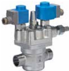
Las válvulas ICLX se instalan en líneas de aspiración para garantizar la apertura contrapresiones diferenciales elevadas, como las que tienen lugar después de un desescarcho por gas caliente en sistemas de refrigeración industrial.
