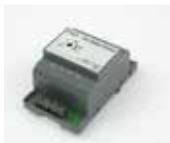
El controlador electrónico VRTMT se emplea para el control de la velocidad en ventiladores AC en equipos de aire acondicionado, refrigeración y calefacción. Basa su funcionamiento en la parcialización simétrica de la tensión en las tres fases, por lo que es ideal para los motores eléctricos asincrónicos ajustables en tensión. Está dotado de conexión Modbus para dialogar con un posible equipo de supervisión a distancia.
